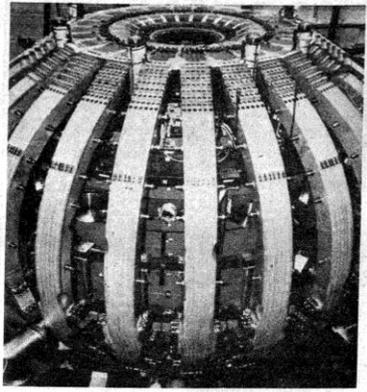
ENERGIA DEL FUTURO (USICA). - La búsqueda continúa en pos de fuentes adicionales de energía. "Doublet III", es el nombre de la máquina de investigación de fusión magnética más grande del mundo, utiliza un concepto de confinamiento magnético para producir energía del hidrógeno, el cual se obtiene fácilmente del agua.
