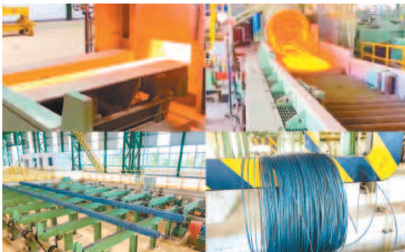
Las barras corrugadas y el alambón que salieron del horno de la Planta de Laminación.
