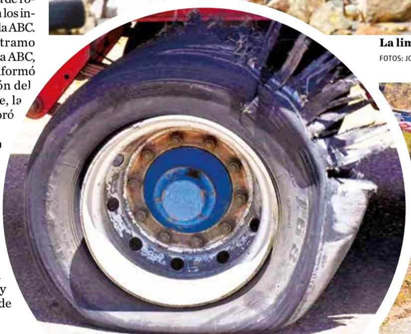
La llanta dañada de un camión por las piedras.
