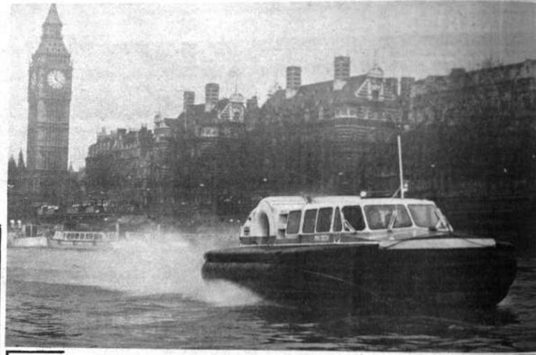
DEMOSTRACION. — Bajo la mirada del Big Ben, el prototipo de un rodotezador británico, el "Cushioncraft 007", hizo su debut público recientemente en el río Támesis, a su paso por Londres. Esta revolucionaria embarcación, posee un método de propulsión por aire en conducto que, se afirma, proporciona un funcionamiento silencioso adecuado para zonas densamente pobladas.
