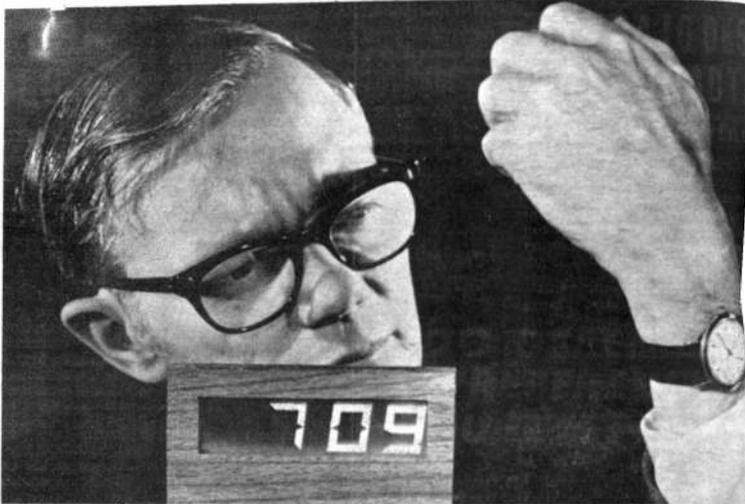
RELOJ ELECTRONICO. Roberto Lohman, científico de la Radio Corporation of América, compara su pasado de moda reloj con una versión completamente electrónica que utiliza un líquido cristal para dar la hora. Este nuevo dispositivo desarrollado en la RCA, emplea una delgada capa de cristal de transparentes cristales yuxtaponidos entre dos placas de vidrio.
