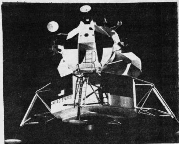
Esta fotografía muestra algunas de las características del Módulo Lunar que pesa 23 toneladas y mide 7 metros de altura. La mita inferior del vehículo, llamada sección para el descenso, se posa en la superficie de la Luna.
