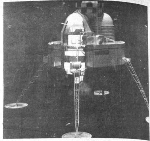
Modelo de una estación investigadora de las profundidades del mar. Diseñado por la Armada norteamericana, tiene capacidad para cinco científicos que pueden vivir un mes a una profundidad de 1.800 metros debajo de la superficie del océano.
