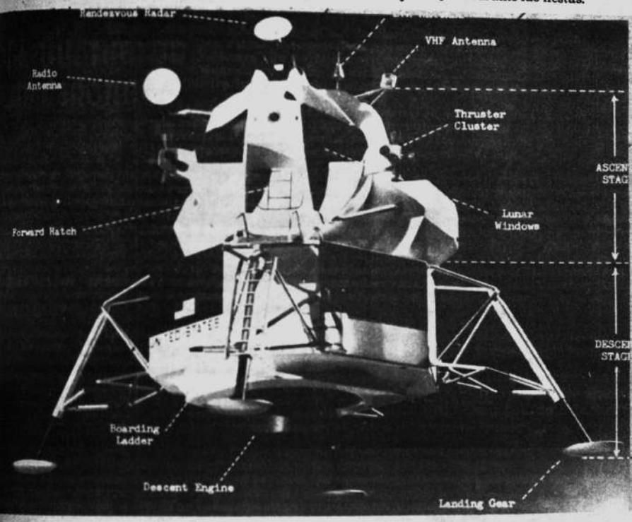
LEM.— La foto muestra algunas de las características del vehículo llamado Módulo Lunar que pesa 23 toneladas y mide 7 metros de altura. La mitad inferior, llamada sección para el descenso, se posará en la superficie lunar. Cuando los astronautas hayan completado su misión, esta sección se quedará en la luna, después de servir de plataforma de lanzamiento para la sección de ascenso.
