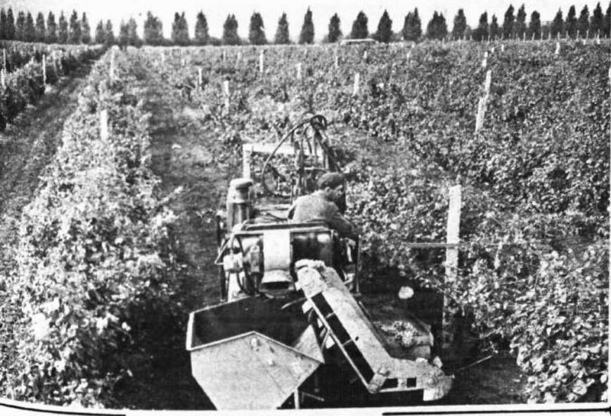
UNION SOVIETICA.— En plantaciones de la estación de pruebas de maquinaria Moldavia, se verifica el funcionamiento de la cosechadora Moldova, que recolecta 2 a 2 y media hectáreas en 7 horas.
