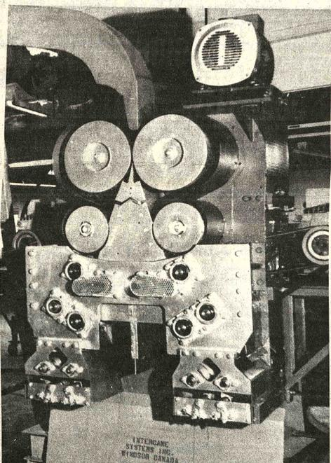
Moderna tecnología para la separación de la cáscara y la pulpa en la caña de azúcar. Sistema "TILBY" exclusivo, inventado y patentado en Canadá. Utiliza solo del 25 al 30% de la energía requerida por el sistema tradicional de molienda.
