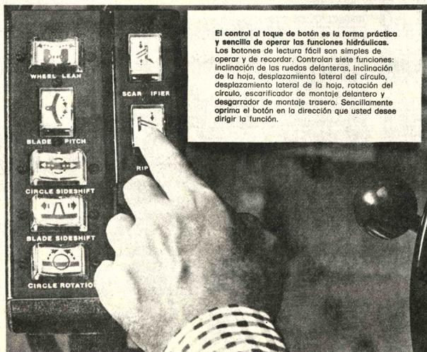
El control al toque de botón es la forma práctica y sencilla de operar las funciones hidráulicas. Los botones de lectura fácil son simples de operar y de recordar. Controlan siete funciones: inclinación de las ruedas delanteras, inclinación de la hoja, desplazamiento lateral del círculo, desplazamiento lateral de la hoja, rotación del círculo, escarificador de montaje delantero y desgarrador de montaje trasero. Sencillamente oprima el botón en la dirección que usted desee dirigir la función.
