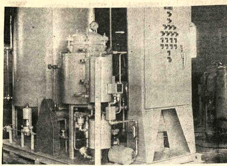
**PURIFICADOR DE ACEITE USADO:** Se ha puesto a la venta en los Estados Unidos, un nuevo depurador de aceite usado, que elimina los contaminantes y lo devuelve casi a su condición original, a razón de 19.000 litros por hora. Este depurador está diseñado para ahorrar energía, usa menos vapor y calor que los modelos anteriores, y se puede amortizar en sólo unas pocas semanas. (USIS).
