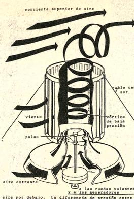
La torre de turbina tiene deflectores verticales ajustables, que se abren a barlovento y se cierran a sotavento. Los deflectores abiertos dirigen tangencialmente el viento que entra en la torre (diagrama a la izquierda) y que se arrastra por el lado opuesto en una espiral de
