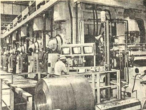
LAMINAS PARA AUTOS - Munich (INB). - El rendimiento es enorme para la fabricación de láminas para automóviles. El rodillo de laminación es capaz de expeler mensualmente 150.000 toneladas de láminas finas para industria automovilística, de ellas 75.000 de lámina de superior calidad.
