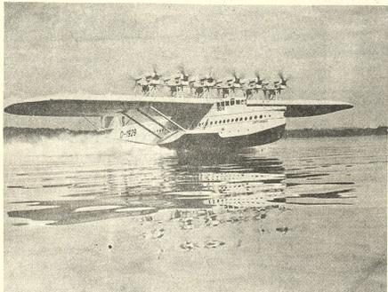
Hidroavión Dornier Do X con 12 motores despegando
