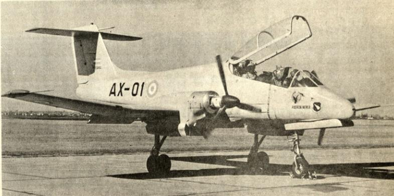
“Pucara”, nave bimotor a turbina producida en la Argentina por la Fábrica Militar de Aviones, de Córdoba.
