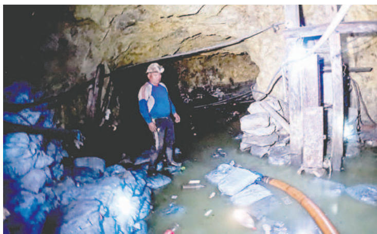
Filtración de aguas ácidas en la mina San José /GAMO Archivo
