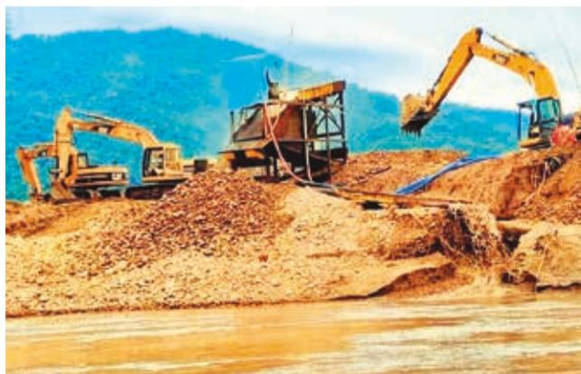
Operaciones para la extracción de oro metálico.
