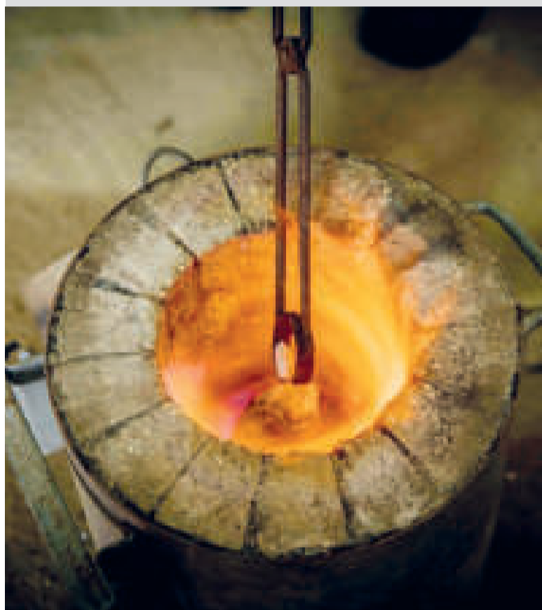
Un horno de fundición de oro que forma parte de las tecnologías limpias.
