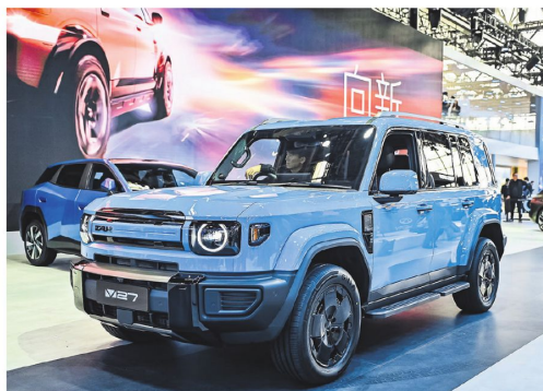
El ICAUR V27 es un eléctrico de rango extendido (EREV) con 449 CV y 1.200 km de autonomía
