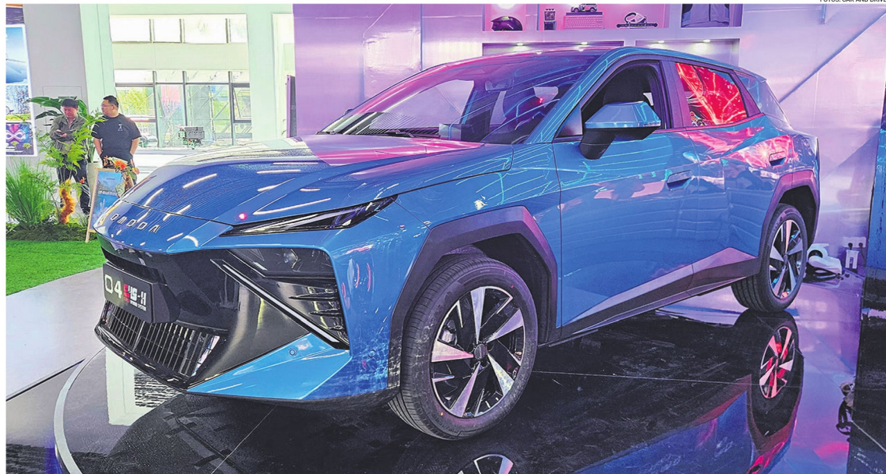
El Omoda 4 es un SUV híbrido SHS con 224 CV y 295 Nm de par máximo combinando un 1.5 turbo de cuatro cilindros con una batería de 1,83 kWh y un motor eléctrico
