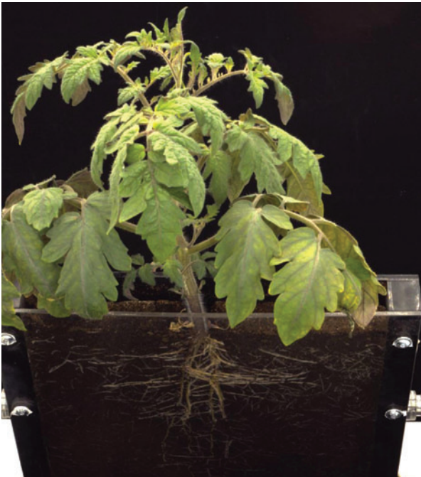
Imagen de un rizotron, una estructura hecha con placas transparentes que exponen el sistema radicular y permite tomar imágenes de la raíz. /EFE
