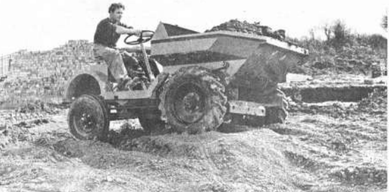
Volquete "55" de gran rendimiento, de la Winget Ltd., Rochester, Kent, Inglaterra, cuya serie incluye modelos de descarga delantera y de plataforma giratoria.
