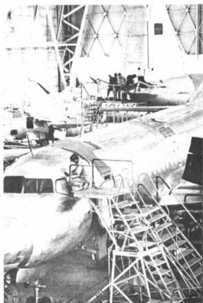
Avión tipo YS-11 en proceso de reavistamiento.
