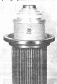
Tubo de emisión refrigerado por agua hirviendo tipo CQ 200-1 en ejecución cerámica-médica completamente concéntrica (Foto Brown Boveri). Potencia máxima de disipación (ánodo) 200 kW. Tensión anódica 22 kV. Potencia máxima de salida 500 kW. Frecuencia máxima 30 MHz.
