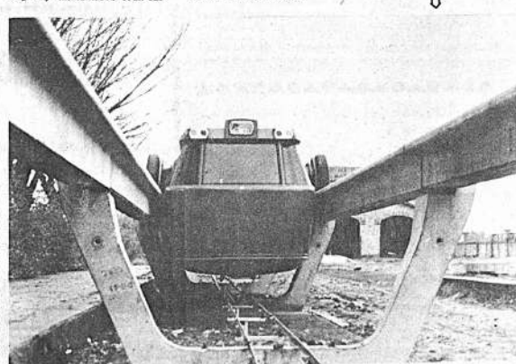
Ariba, una vista general de la presa de Alcantara, el mayor embalse de Europa Occidental. Abajo, prototipo del tron' vertebreado español, es de plástico, ultraligero, no puede descarrilar y es más barato.
