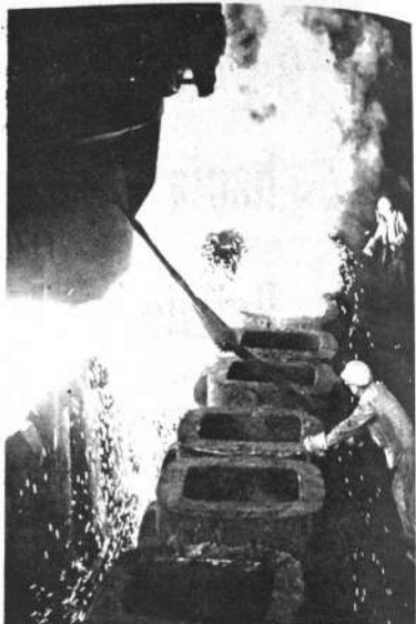
INDUSTRIA DEL ACERO: vaciado del acero líquido en las lingoteras.
