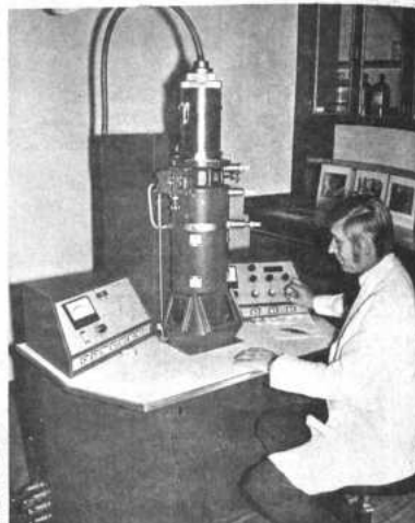
Un microscopio electrónico de alta definición puede costar 20 mil libras, pero la mayoría del tiempo no se emplea para altas definiciones. Ahora se ofrece uno nuevo, que amplía de X 50,000 a X 80,000 proyectado específicamente como instrumento de definición media, a precios de 6,500 a 8,000 libras. El microscopio Polaron MR-60 tiene aplicaciones en biología, química, física, usos industriales y, como sus principios de funcionamiento se pueden demostrar muy fácilmente, en universidades y escuelas técnicas.
