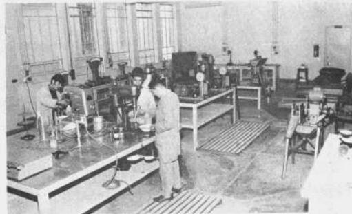
Laboratorio de concentración de la cátedra de preparación de Minerales. Aquí se efectúan las pruebas por gravimetría, realizada por los estudiantes de los últimos cursos de la Sección Minas.
