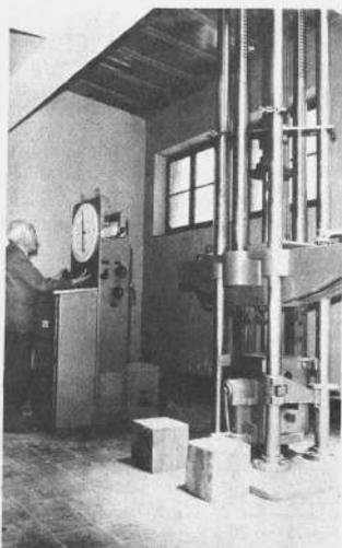
Laboratorio de Resistencia de Materiales, en el que se efectúan las pruebas de compresión, tracción, torsión etc. Varias instituciones de Potosí, se valen de las ventajas de este equipo.
