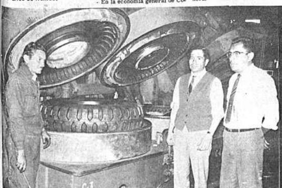
Uno de los modernos equipos de vulcanización de la fábrica de llantas Zimeri Boliviana. En la fotografía aparecen los técnicos Benito Lozano y Javier Areola. Junto a ellos un obrero de la fábrica.
