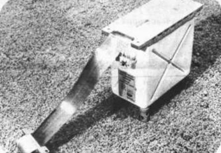
Este instrumento que será colocado en la superficie lunar, medirá las partículas cargadas de electricidad, estudiará la distribución de la energía y las variaciones de tiempo de los flujos de protones y electrones. También servirá para medir los rayos cósmicos solares de baja energía en casos de erupciones y explosio- nes solares.
