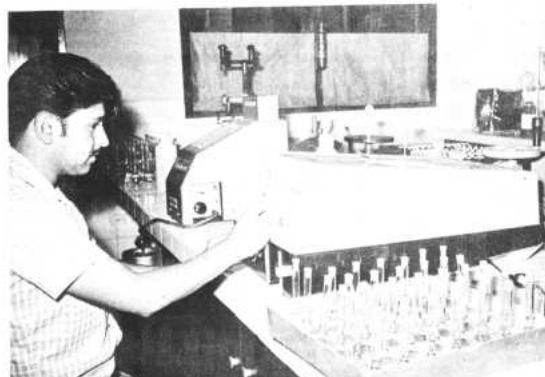
La determinación de minerales en los suelos se realiza con equipos de alta precisión. Un técnico (en la fotografía) obtiene datos en el "Espectrómetro Atómico de Absorción" y de un Fotómetro de Llamas (izquierda). Estos equipos están instalados en el laboratorio de suelos de los Asesores Británicos en Agricultura Tropical.
