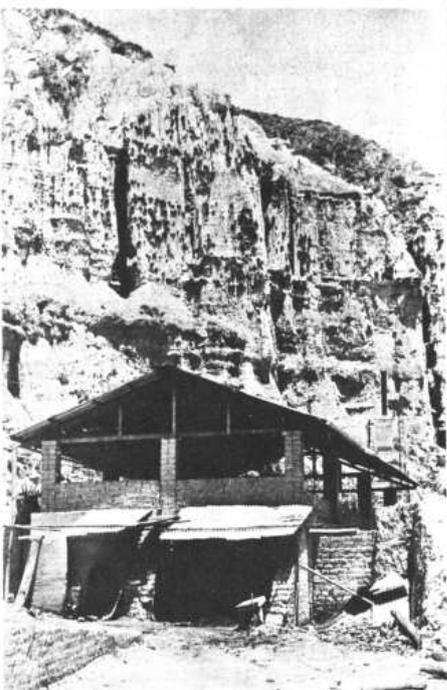
Este es un galpón en el cual está instalado un horno para la producción de ladrillos que a la fecha produce cerca de 20,000 ladrillos.
