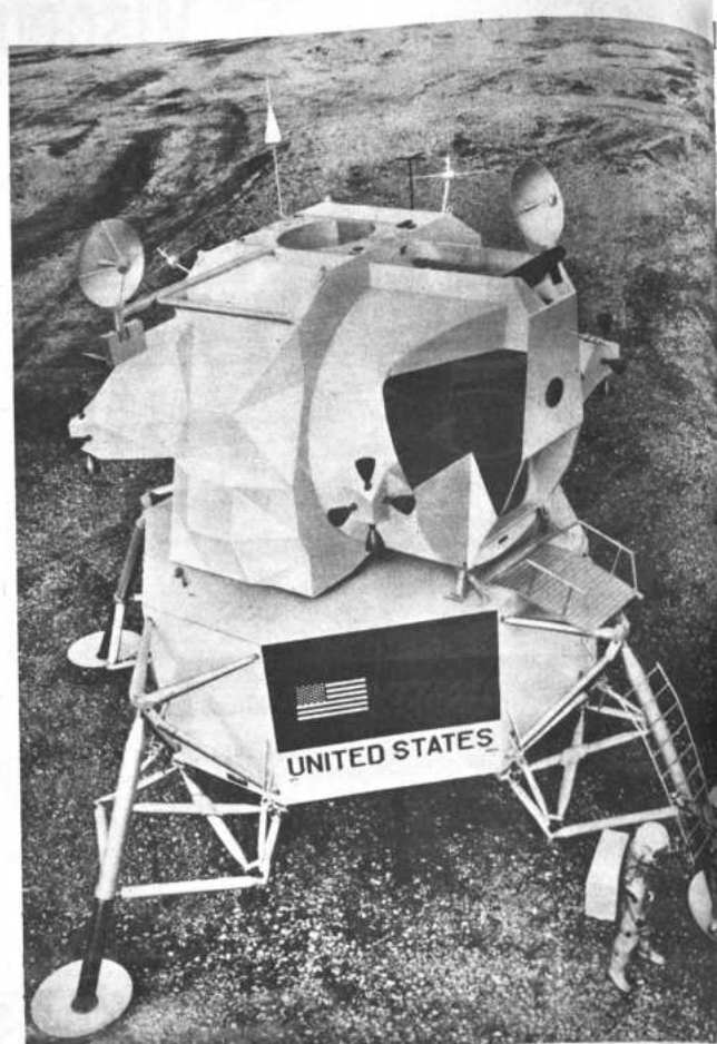
El módulo lunar, con el cual los norteamericanos piensan llevar sus astronautas a la Luna. El módulo tiene una altura de siete metros.
