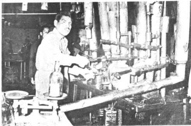
El proceso de elaboración de la botella, se observa en este obrero de la Fábrica de Vidrios, que provisto de guantes especiales realiza el principal cometido en la sala de producción, donde existen hornos de alta presión calorífica.
