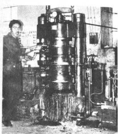
La fotografía muestra la Prensa con bomba hidráulica para extraer mantequilla de cacao. La maquinaria corresponde a la Fábrica de Chocolates "Taboada".
