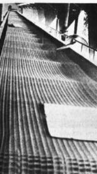
Banda de rodaje de 170 metros de largo, destinada al entrenamiento de la goma.
