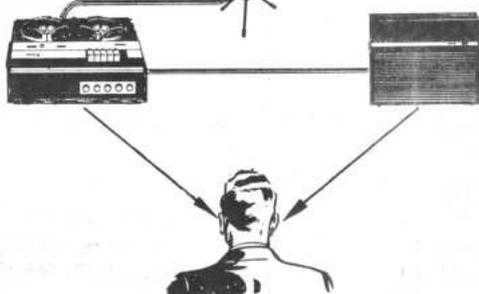
Con un magnetófono estereofónico, se emplean dos micrófonos para captar los sonidos de la izquierda y de la derecha, de la misma forma que lo hacen los dos oídos de una persona. La corriente de estos micrófonos pasa a amplificadores separados y es grabada en dos pistas distintas de la cinta magnética. De este manera quedan registradas las diferencias de tiempo y de intensidad sonora.
