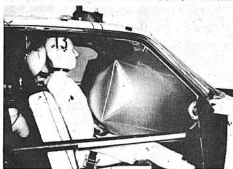
Detroit, 13 (AP).- Dos moniques se ven impedidos de chocar contra los cristales y tablero de instrumentos de un automóvil por un sistema de amortiguación que se llama de aire en menos de un segun- do al recibir señal de un sensor de impacto. El sistema fue des- cripto en un trabajo presentado por la Ford Motor Co. en la reunión de ingenieros automotivos que se celebra en Detroit. (AP RADIO- FOTO).
