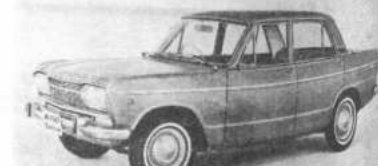
PMC, PRINCE a 150 DX, cuatro cilindros, motor 1484 cc., 73 hp, cinco asientos, máxima velocidad 140 kph.
