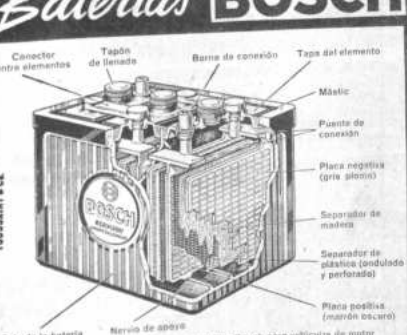
Fig. 1 Estructura de una batería de plomo Bosch para vehículos de motor
