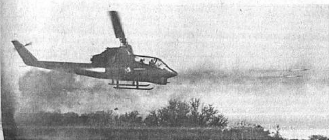
Primer helicóptero que sirve como plataforma aérea para lanzamiento de cohetes. Tiene una capacidad de conducción de 70 cohetes, ametralladoras para disparar 4,000 cartuchos por minuto y un lanzador de granadas. Su velocidad máxima es de 350 kilómetros por hora.
