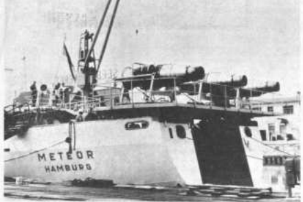
Aspecto descomunal ofrece la popa del buque de exploración "Meteor" del Instituto Hidrográfico Alemán de Hamburgo. Lleva tres grupos de propulsión por reacción de un empuje total de toneladas que accionan el barco como un avión. Es la primera vez que se cumplen ensayos con motores turbo-reactores, en un buque de estas dimensiones.
