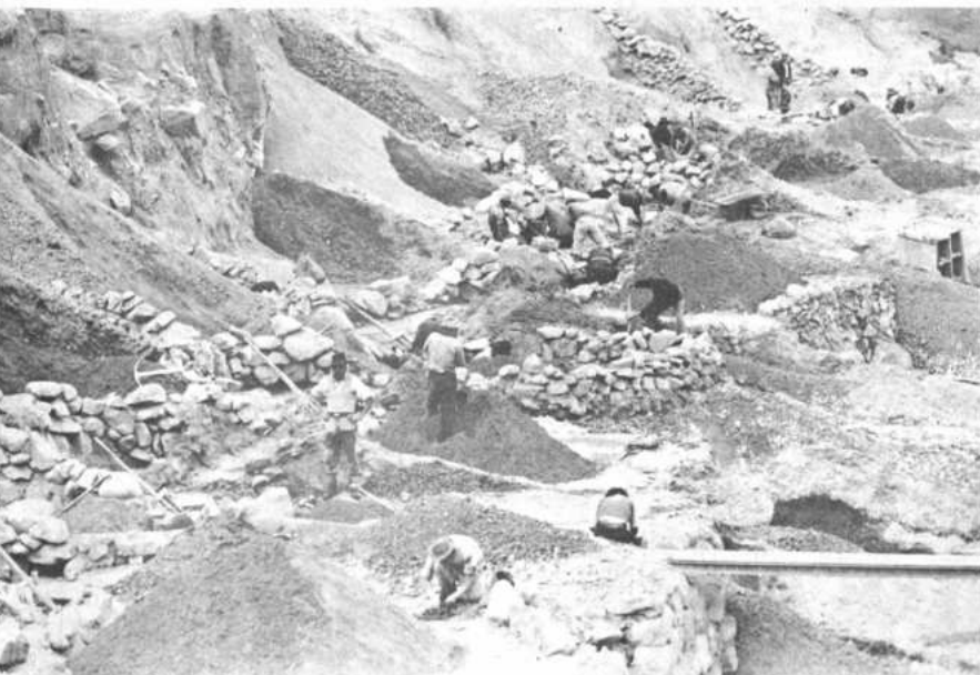
Numerosos grupos de trabajadores explotan el sistema de relave, buscando en un segundo lavado, partículas de mineral mezcladas con barro el cual es amontonado y pasado por un filtro primitivo. Trabajadores de relaves y venteros operan en cuadrillas que entregan luego el producto de su trabajo para el ingenio.
