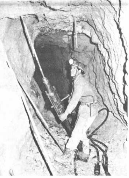
Este perforista, con su típico montón de coca en la boca, es sometido a un procedimiento especialmente dañino para la salud por la fuerza de la vibración de su máquina. En muchos sectores el perforista posee un buen filtro para la boca y se mueve en un espacio más cómodo.
