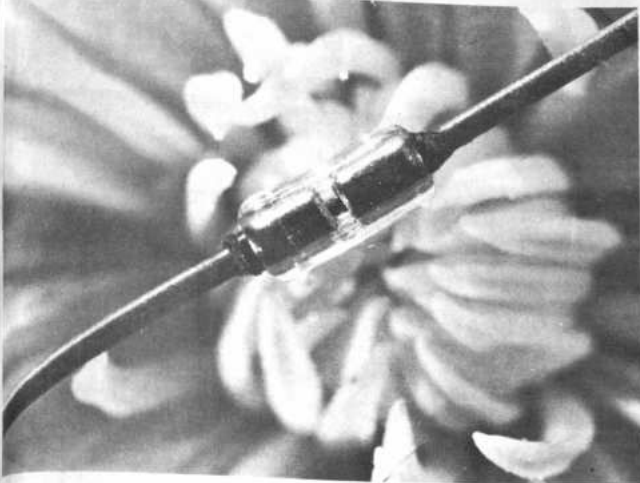
El diamante artificial, visible como un punto negro dentro de su caja de vidrio transparente, sirve como elemento sensorio en este delicado termómetro desarrollado en los Estados Unidos.
