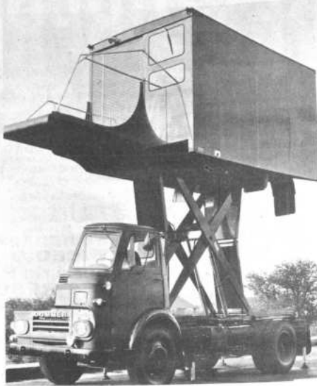
El primero de 4 vehículos especiales de carga "Hi-Lift", pedidos a la Gran Bretaña por la Scandinavian Airlines System, demuestra su habilidad al levantar la carrocería a una altura de 4 metros con sólo apretar un botón.
