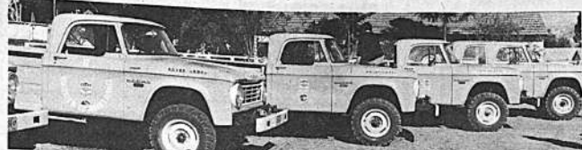
Los vehículos entregados por USAID, "Dodge", de doble tracción, han sido especialmente diseñados para trabajos en las áreas rurales de los países, equipados de guinchos, calefacción y cinturones de seguridad. Tres de los doce tienen doble cabina.
