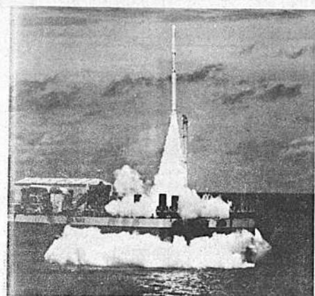
PRIMERA PLATAFORMA MARINA DE LANZAMIENTO. Momento en que un cohete norteamericano Scout arranca de una plataforma de lanzamiento, anclada a cinco kilómetros de la costa de Kenia, para poner en órbita el satélite italiano San Marco-2. Un grupo de técnicos italianos encendió por control remoto, desde una segunda plataforma cercana, el cohete de cuatro secciones. Fue la primera vez que se lanza una nave espacial desde una plataforma anclada en el mar, y también la primera vez que un satélite se colocó en órbita ecuatorial. El San Marco-2, diseñado y construido por científicos de la Comisión Italiana de Investigación Espacial, lleva equipos para medir la densidad atmosférica ecuatorial. El San Marco-1 fue lanzado por un grupo de técnicos italianos el 15 de diciembre de 1964 desde la isla de Wallops, Virginia.
