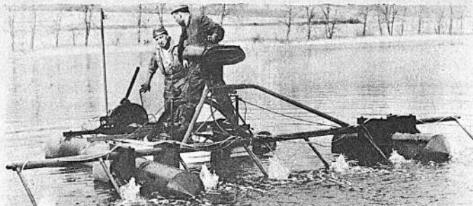
Un arma eficaz contra plantas marinas indeseables es esta máquina flotante desarrollada por un fabricante alemán. La "vacuum marina" mecánica aspira, a través de toberas neumáticas, a los tallos de las plantas un producto venenoso que destruye su clorofilo. Naturalmente, el veneno es inofensivo para el hombre y el animal. La foto muestra la citada máquina.
