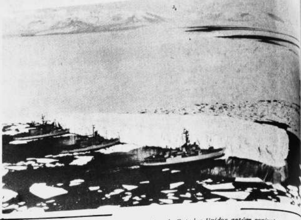
Tres rompehielos de la marina de Estados Unidos actúan conjuntamente para mover un iceberg que obstruía el canal de ingreso a la estación de McMurdo, en la Antártida. La parte visible del iceberg, la que asoma sobre el agua, es sólo la octava parte del total. La fotografía, aunque tomada el 29 de diciembre, fue hecha públicamente (AP Wirephoto)
