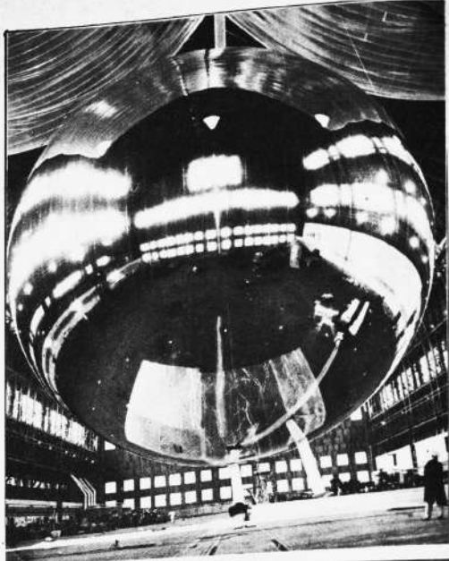
PRUEBA DE INFLADO.— El Págeos, satélite esférico de 30 metros, que será colocado en órbita polar este año, es sometido a prueba en Lakehurst, New Jersey. Las estaciones de tierra podrán fotografiar al satélite altamente reflector en órbita, teniendo como fondo las estrellas, para ayudar a los científicos a obtener datos precisos sobre la localización de puntos específicos sobre la Tierra.
